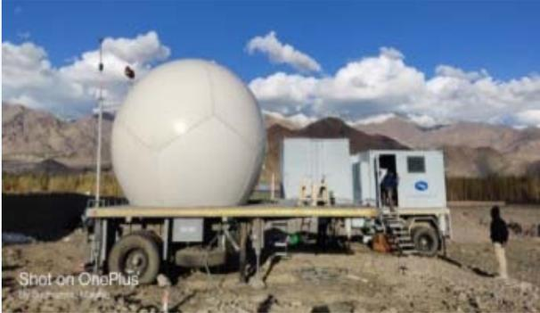
**Fig. 36. Portable X-Band Doppler Weather Radar**
